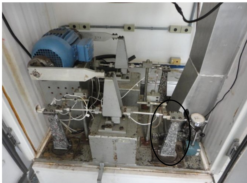
Figura 5: Aparelho e ensaios à flexão de 2 pontos
